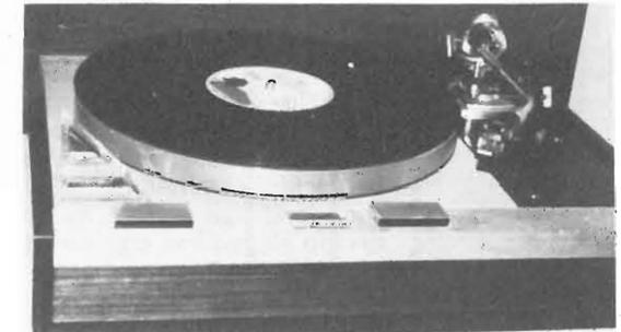
Se il giradischi non è in piano bisogna agire sulle viti interne che sollevano il piano del giradischi (ogni marca ha il suo sistema: il THORENS delle fotografie ha dei grossi cilindri bianchi all'interno) o in mancanza di queste si possono inserire degli spessori sotto i piedini della base o del piatto. Per i più curiosi il braccio in fotografia è un ACOS-LUSTRE e la testina una SHURE V-15 III. Buon... controllo!
